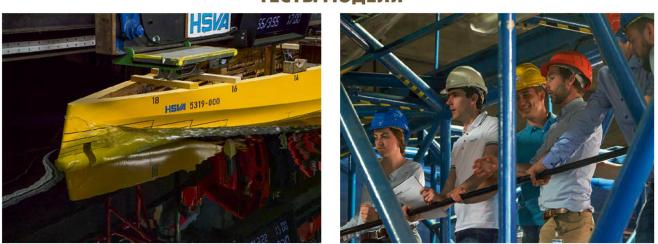
Испытания масштабной модели Black Shark проводили в Гамбурге, в опытовом бассейне HSVA, где особое внимание уделили тестам мореходных качеств корпуса с обратным наклоном форштевня, а также интенсивности формирования брызг в носовой части на разных режимах движения. Благодаря оптимальным обводам корпуса и плавниковым успокоителям качки Zero Speed на борту яхты будет комфортно даже на максимальной скорости, которая составит 16-17 узлов.
